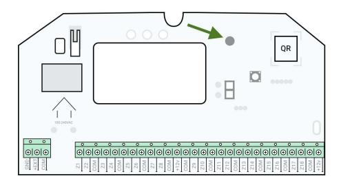
Die MultiTransmitter-LED-Anzeige kann je nach Status des Geräts weiß, rot oder grün aufleuchten. Bitte beachten, dass die LED-Anzeige bei geschlossenem
